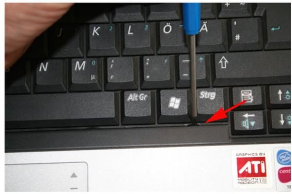
Damit man das Flachbandkabel der Tastatur besser abziehen kann, sollte man die gesamte Tastatur umklappen (siehe Bild).
